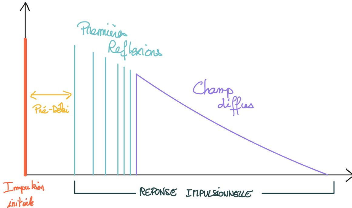
Figure 3.1: Schéma d'une réponse impulsionnelle de réverbération.
