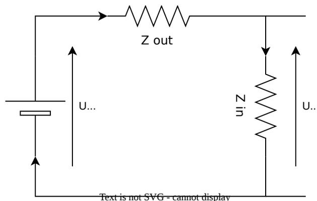
Dans ce circuit,  $Z_{eq} = Z_{in} + Z_{out}$  et  $U_{out} = Z_{eq} \times i$ . Alors,  $i = \frac{U_{out}}{Z_{eq}} = \frac{U_{out}}{Z_{in} + Z_{out}}$ . Toujours grâce au circuit ci-dessus, on peut dire que  $U_{in} = Z_{in} \times I$ . En remplaçant dans l'expression précédente on trouve :  $\frac{U_{in}}{Z_{in}} = \frac{U_{out}}{Z_{in} + Z_{out}}$
