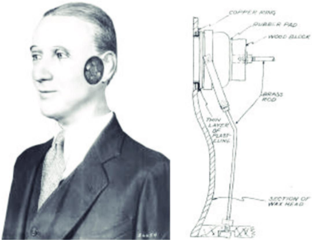
Figure 33.4: Oscar : premier dispositif d'enregistrement binaural
