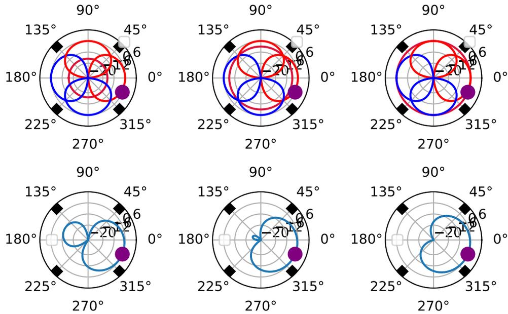
Figure 37.7: Décodage par projection basique, maxRe et inPhase.
