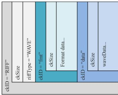
Figure 38.2: Structure d'un fichier wave
