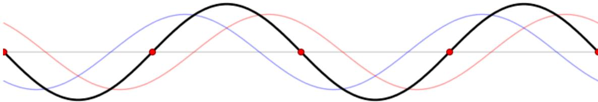
Figure 3.2: Les points rouges représente les noeuds, les amplitudes maximales sont les ventres.
